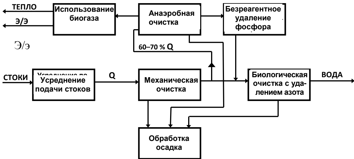
Рис. 8.1. Основные этапы очистки сточных вод свинокомплекса «Надеево»
